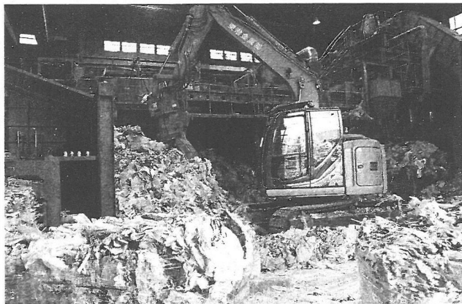
回収先から運ばれてきた廃棄物を選別、破碎した後、梱包してリサイクル業者などに運ぶ。東京都大田区京浜島の東港金属で6日
